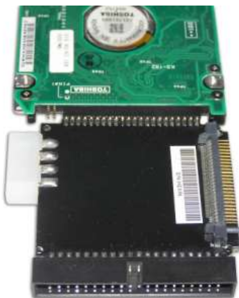
Подключение адаптера к 2,5" PATA НЖМД
