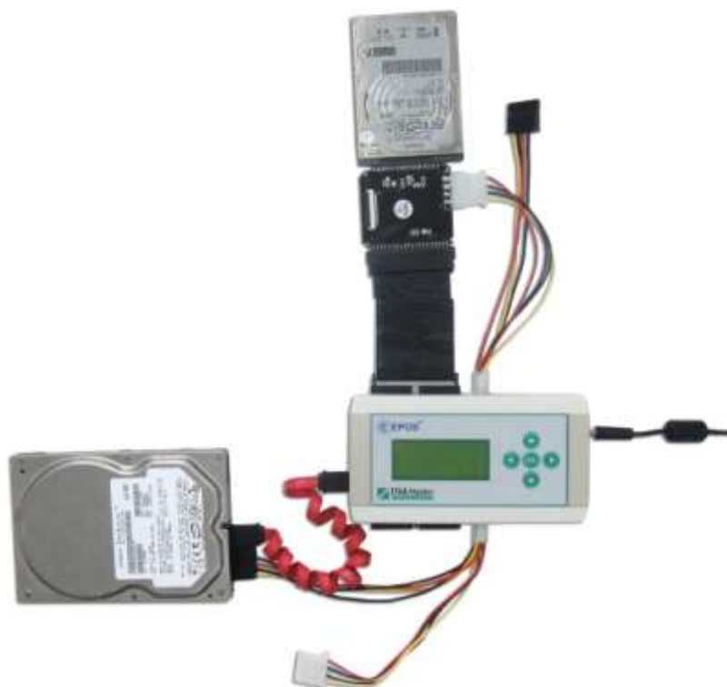
Подключение 2,5" PATA НЖМД к адаптеру
