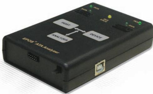
Анализатор разработан с учетом требований инженеров и разработчиков, которым необходим простой в использовании, но функциональный инструмент, обеспечивающий возможность работы как в стационарных условиях, так и на выезде. Он подключается к ноутбуку (или другому инструментальному ПК) по высокоскоростному интерфейсу USB 2.0 и обеспечивает регистрацию, сохранение и обработку протоколов взаимодействия устройств с интерфейсами ATA.
